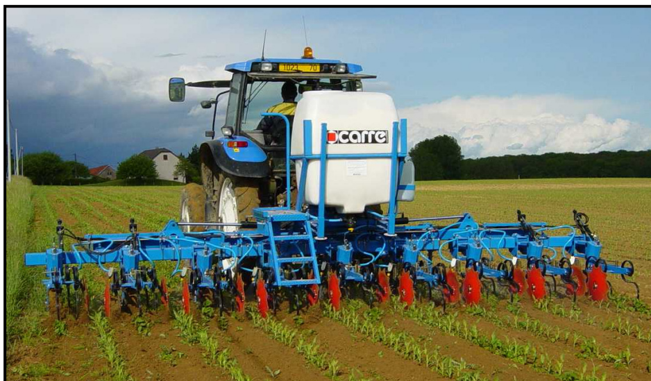
Figure 39 : Désherbineuse utilisée dans un champ de maïs Source : Société Carré
